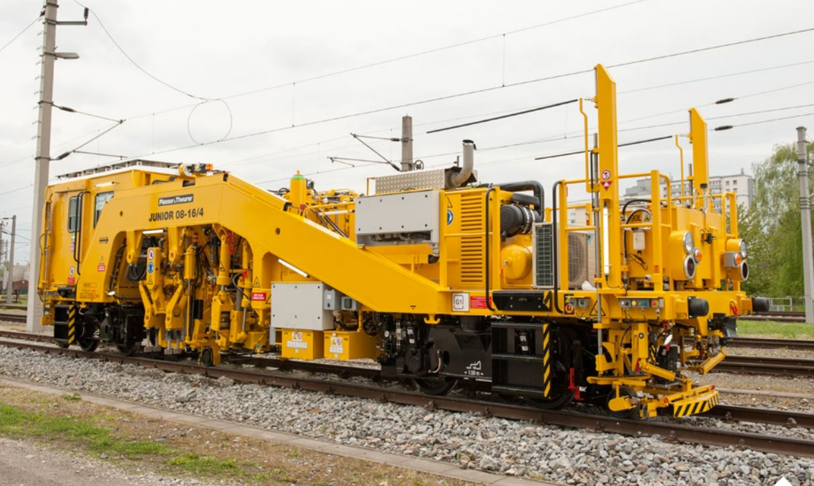
Junior 08-16/4は高性能のリフティング・ライニング機能を持つ、連続作業可能なマルチです。強固なフレームと走行性能により、安定的かつ正確な作業を実現します。
