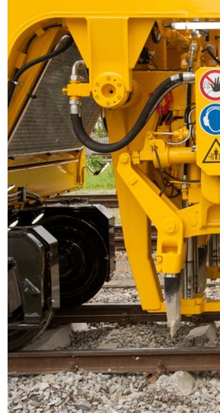
Junior 08-16/4は高性能のリフティング・ライニング機能を持つ、連続作業可能なマルチです。強固なフレームと走行性能により、安定的かつ正確な作業を実現します。
