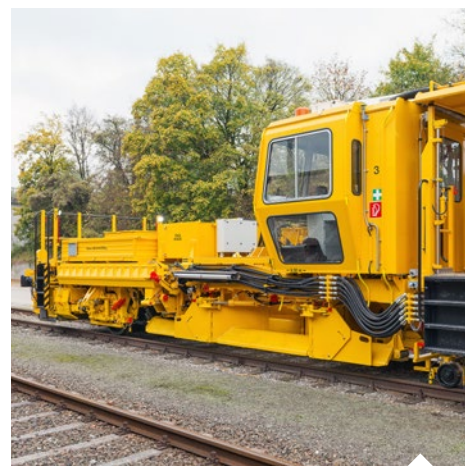
道床整正プラウおよびスウィーパーユニット
