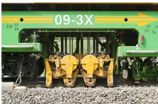
3丁突きタンピングユニットにより、マクラギ3本を同時に締め固め
