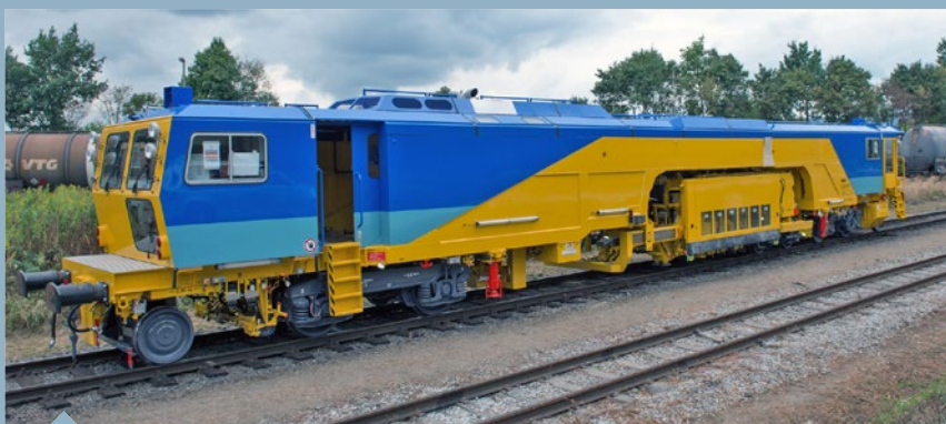
09-2X/SHはタンピングユニット部の左右横に防音壁を装備
