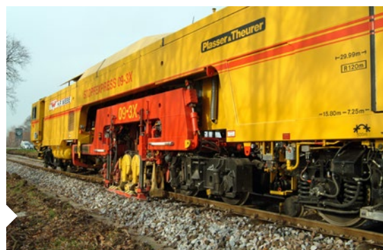
3丁突きタンピングユニットにより、マクラギ3本を同時に締め固め
