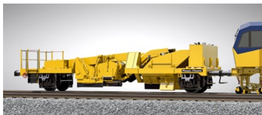
スプリットヘッド技術、旋回可能なタンピングツール、レール3本こう上
