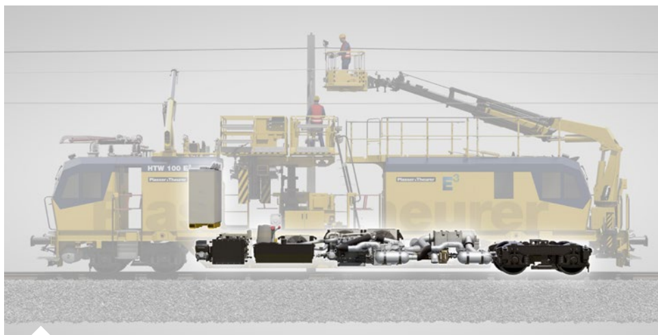
作業6時間に対応するバッテリー容量はモジュール拡張も可能。冷却温度管理と外部空熱ポンプにより、外部温度の影響を受けず、常に安定した性能を発揮
