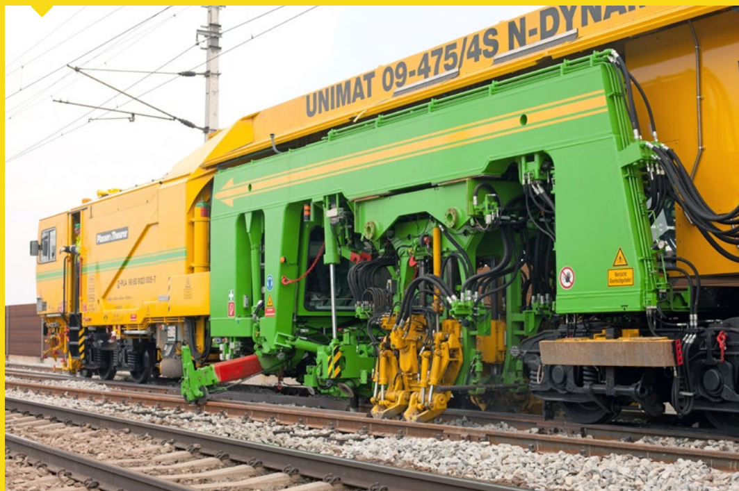
Unimat 09-475/45 N-Dynamicに搭載された分岐作業支援システムのプロトタイプ
