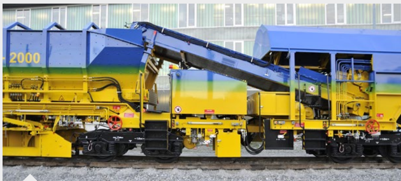
バラストホッパーの容量は15m 3 、効率よい道床交換作業を実現
